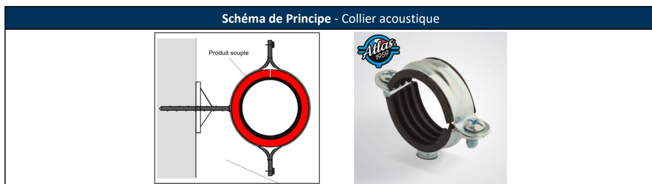
Figure 30 : Schéma de Principe - Collier acoustique
